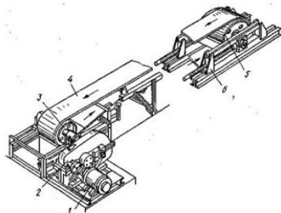
Рисунок 4. Ленточный конвейер: 1 — электродвигатель, 2 — редуктор, 3, 5 ведущий и ведомый барабаны, 4 — лента, 6 натяжное устройство.
